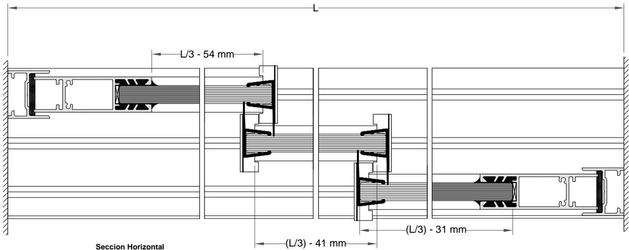
E: 1/250 COTAS EN mm. Todas las medidas de corte se han calculado en base al dimensionado de los perfiles. Se aconseja su verificación por el fabricante para su validación.
